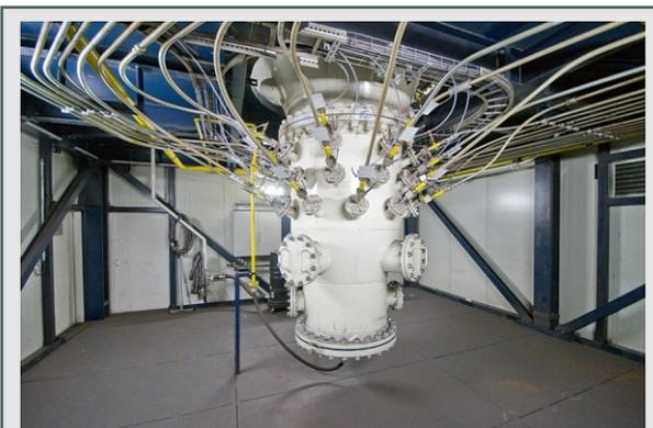
*Dynamisches Verteilergefäß mit Dosierleitungen*
