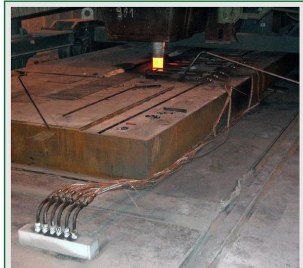
Förderleitungen zum 6-fach Verteiler an einer Brammenanlage
